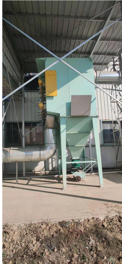
图 3-3 废气处理装置（旋风除尘器和布袋除尘器）
