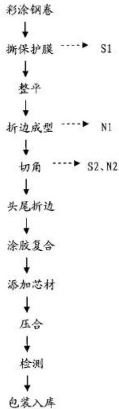
图 2-2 L 兴利、M 兴德、S 兴彩系列生产工艺流程及产污节点图
